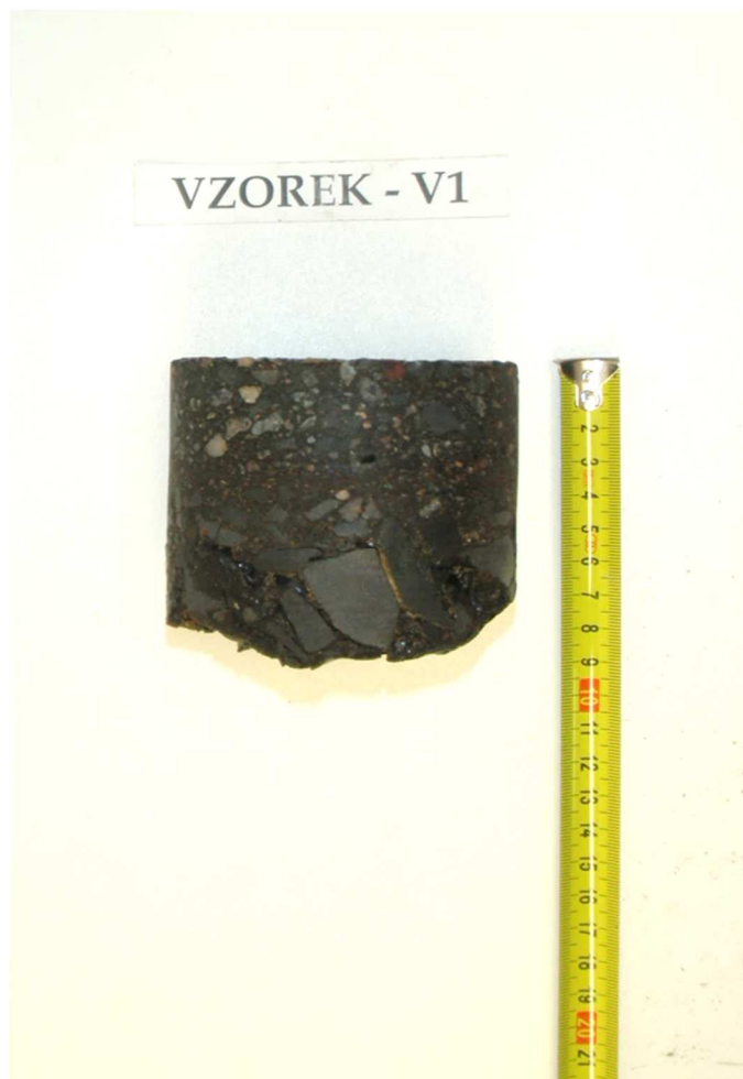
Obr. 2 - Jádro vývrtu Vzorek – V1 (laboratoř).
