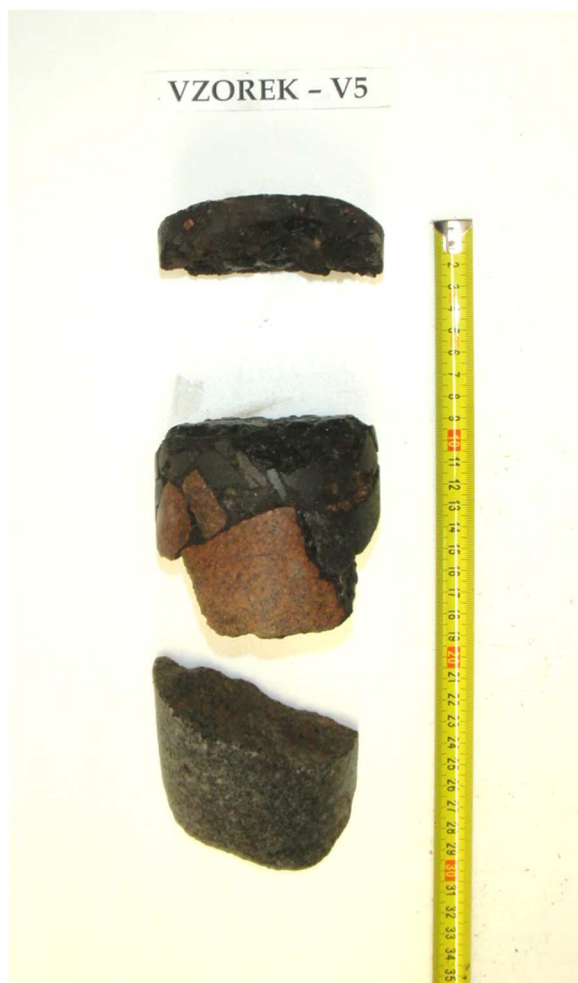
Obr. 10 - Jádro vývrtu Vzorek – V5 (laboratoř).
