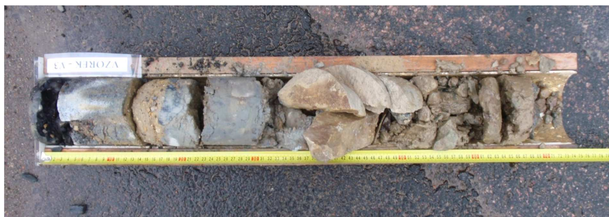
Obr. 5 - Jádro vývrtu Vzorek – V3 (in situ).
