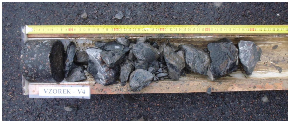
Obr. 7 - Jádru vývrtu Vzorek – V4 (in situ).
