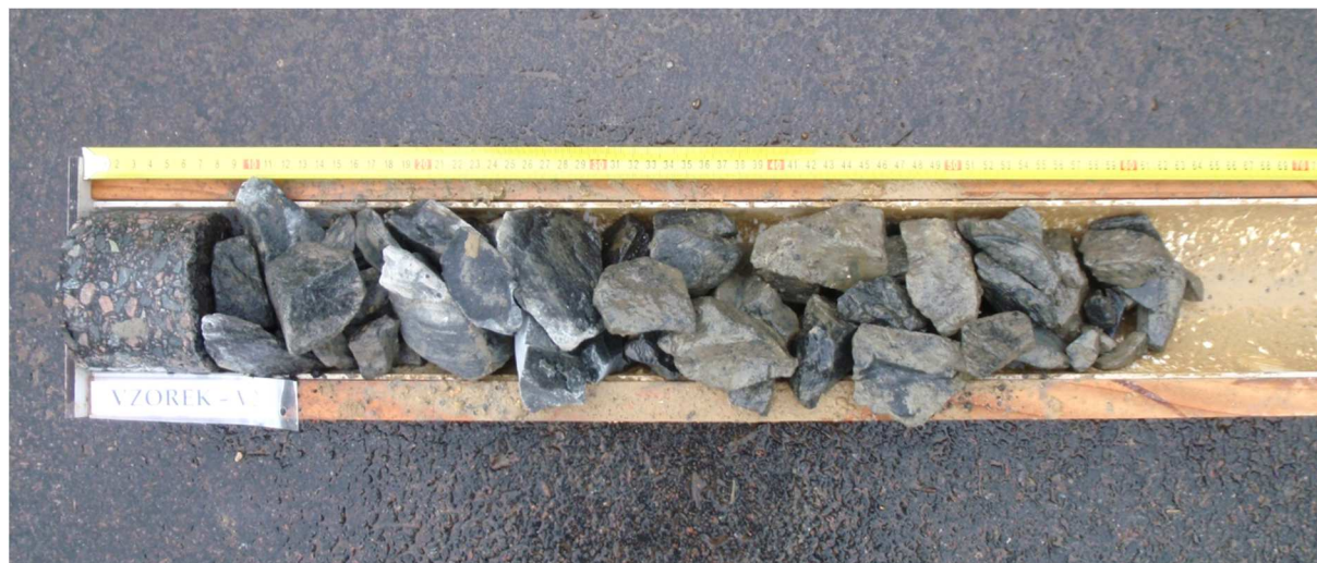
Obr. 3 - Jádro vývrtu Vzorek – V2 (in situ).
