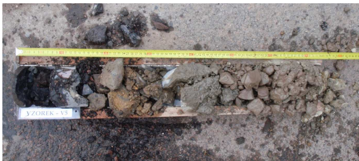
Obr. 9 - Jádro výtvetu Vzorek – V5 (in situ).
