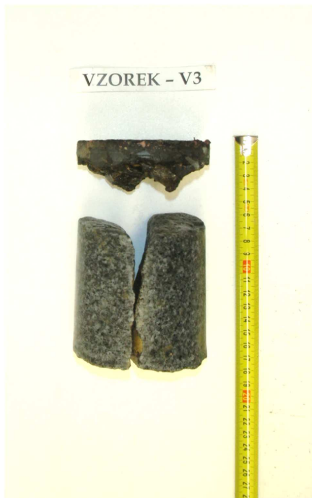
Obr. 6 - Jádru vývrtu Vzorek – V3 (laboratoř).
